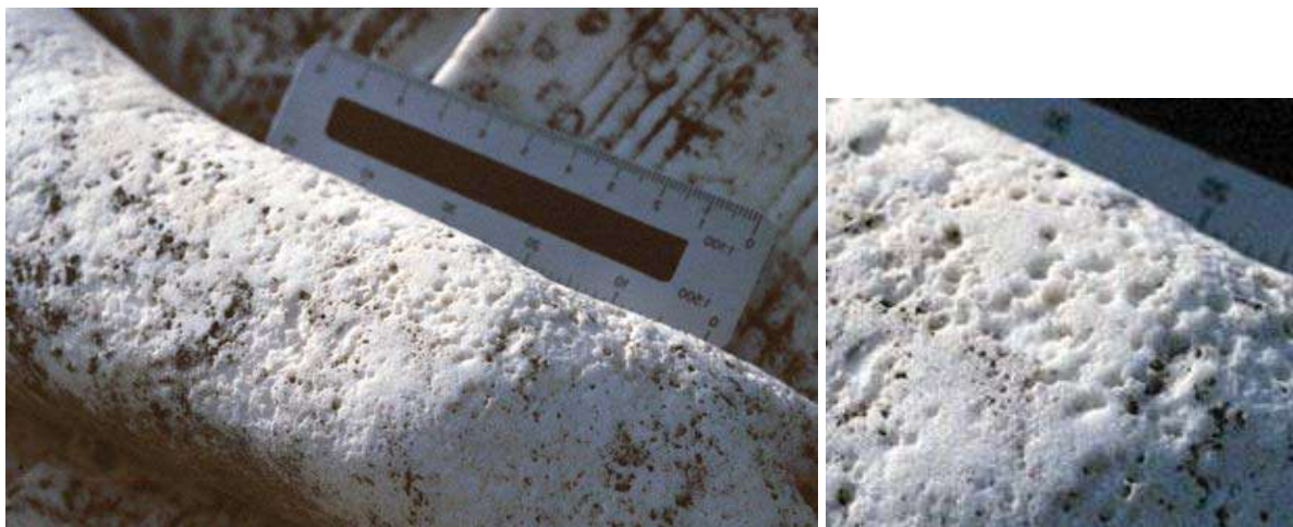
Slika 16: Udubljivanje do kojeg dolazi na mramornoj skulpturi. Vjerovatno se radi o mikrobiološkom porijeklu
