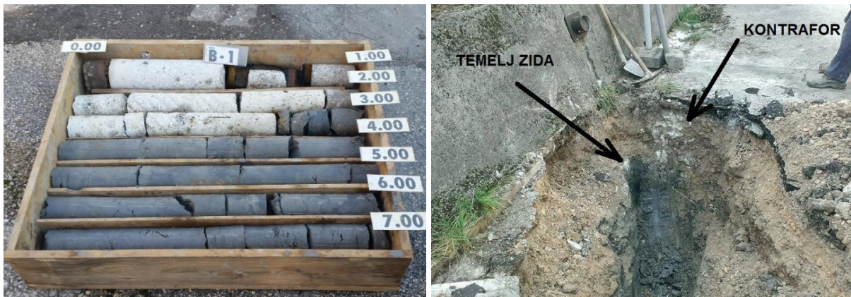
Slika 3. Fotografije: izbušene jezgre (lijevo); istražnog raskopa (lijevo) 3
