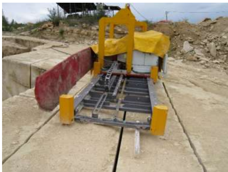
Slika 1. Mašina za rezanje kamena na kamenolomu Maskara (foto Hajdarević, 2012)
