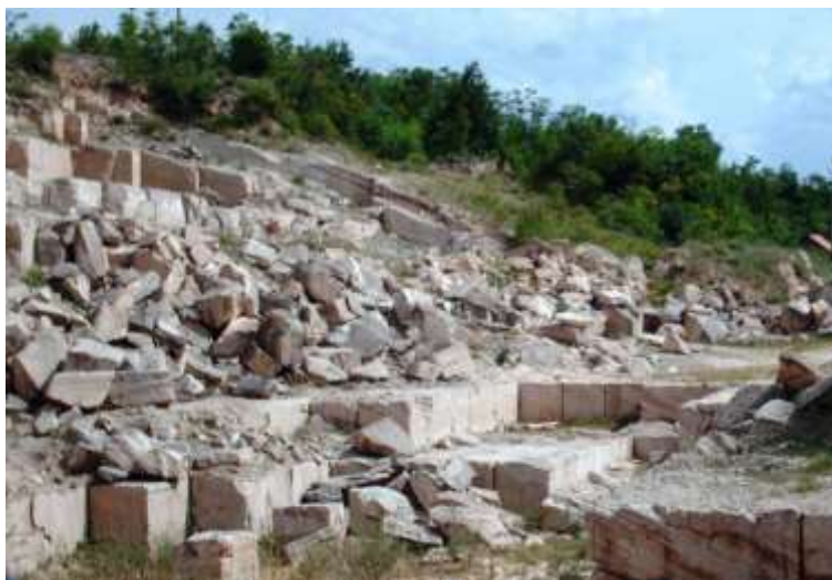
Slika 15. Dio kamenoloma Mukoša na kome se eksploatisao oolitični krečnjak – tenelija za potrebe izgradnje Starog mosta (foto Hajdarević, 2006)
