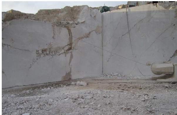
Slika 10. Mašina sa reznom sajlom u radu na kamenolomu Ladina (foto: Hajdarević, 2015)
