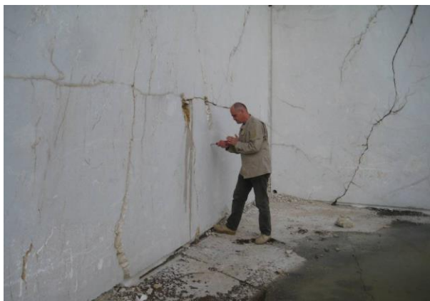
Slika 8. Ispitivanje Šmitovim čekićem na istražno-eksploatacionoj etaži (foto Šerifović, 2014)
