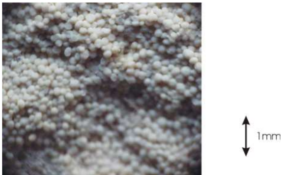
Slika 11. Struktura tenelije je oolitična (SEM snimka – LGA Nürnberg)
